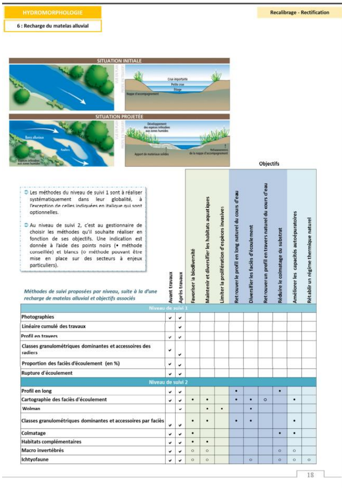
Figure 21 : Indices de suivi préconisés lors d'une recharge granulométrique (source : « Aide à l'élaboration d'un programme pour le suivi des travaux de restauration de cours d'eau (continuité et hydromorphologie) : Guide à l'usage des gestionnaires de milieux aquatiques » : AFB)
